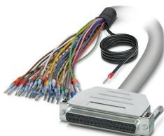
Câble rond blindé préconfectionné; raccordement 1 : Fils individuels (37-pôles) (Les fils sont repérés et équipés d'embouts. La tresse de blindage sort d'une extrémité de câble distincte.); raccordement 2 : Connecteur femelle D-SUB (1x 37-pôles); longueur de câble: 2 m
