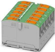
Bloc distributeur, tension nominale: 450 V, intensité nominale: 24 A, nombre de connexions: 12, nombre de pôles: 1, type de raccordement: Raccordement Push-in, Section de référence: 2,5 mm<sup>2</sup>, section : 0,14 mm<sup>2</sup> - 4 mm<sup>2</sup>, type de montage: collage, coloris: vert
