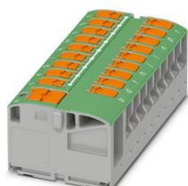
Bloc distributeur, tension nominale: 450 V, intensité nominale: 24 A, nombre de connexions: 19, nombre de pôles: 1, type de raccordement: Raccordement Push-in, Dérivation, Section de référence: 2,5 mm<sup>2</sup>, section : 0,14 mm<sup>2</sup> - 4 mm<sup>2</sup>, Raccordement collectif, Section de référence: 6 mm<sup>2</sup>, section : 0,5 mm<sup>2</sup> - 10 mm<sup>2</sup>, type de montage: collage, coloris: vert
