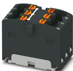
Bloc distributeur, pontage interne, tension nominale: 450 V, intensité nominale: 17,5 A, nombre de connexions: 6, type de raccordement: Raccordement Push-in, section : 0,14 mm<sup>2</sup> - 2,5 mm<sup>2</sup>, type de montage: encliquetage sur l'adaptateur de profilé, Montage direct avec bride, Volant, coloris: noir
