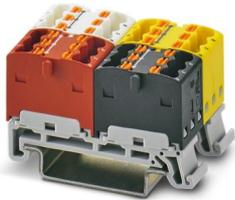
Bloc distributeur, Pour bus KNX dans l'installation électrique de bâtiment, bloc individuel avec pontage interne, couleur selon le codage de câble EIB, agencement par paire, tension nominale: 500 V, intensité nominale: 17,5 A, nombre de connexions: 24, type de raccordement: Raccordement Push-in, section : 0,14 mm<sup>2</sup> - 2,5 mm<sup>2</sup>, type de montage: NS 35/7,5, NS 35/15
