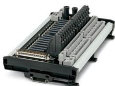
Élément de base VIP I/O-Marshalling à 16 canaux pour une utilisation universelle. Modules d'approvisionnement et de terrain enfichables disponibles en tant qu'accessoires. Technologie de raccordement Push-in ou à vis au choix. Compatible avec la série Tricon CX DCS (D-SUB 50).
