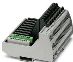
Élément de base VIP I/O-Marshalling à 8 canaux pour une utilisation universelle. Tous les raccordements sont vissés. Compatible avec les séries Honeywell C300 et RUSIO grâce au connecteur MINICONNEC. Repérage des canaux 17 à 24 et peinture.
