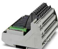
Élément de base VIP I/O-Marshalling à 8 canaux pour une utilisation universelle. Tous les raccordements sont vissés. Compatible avec les séries Honeywell C300 et RUSIO grâce au connecteur MINICONNEC. Repérage des canaux 9 à 16 et peinture.
