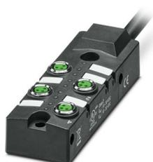
Boîtier répartiteur, application : Standard, type de raccordement: Connecteur femelle M8 Métal, nombre de prises: 4, nombre de pôles: 3, détrompage: A, affectation des prises: simple, affichage d'état: Oui, pnp; racc. câble multicond.: Connexion fixe 180°, PUR/PVC, longueur du câble: 5 m, blindage: non
