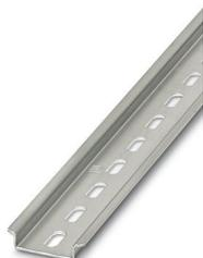
Profilé percé, Conditionnement par 25 unités (50 m), selon EN 60715, matériau: Acier, galvanisé, traité par passivation couche épaisse, Profil standard, coloris: argent
