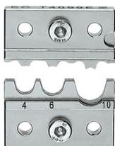
Matrice pour automate à sertir CF 500, pour cosses tubulaires 4 ... 10 mm<sup>2</sup>, **4 mm<sup>2</sup>** : Ø extérieur 5 mm, Ø intérieur 3 mm, **6 mm<sup>2</sup>** : Ø extérieur 6 mm, Ø intérieur 4 mm, **10 mm<sup>2</sup>** : Ø extérieur 8 mm, Ø intérieur 5 mm
