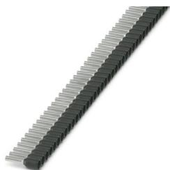
Embouts en bande, 1,5 mm<sup>2</sup>, longueur d'embout 8 mm, avec collets en plastique, selon DIN 46228-4, coloris noir, dotés d'une extrémité fonctionnelle pour un traitement sûr et facile avec Crimphandy, 20 bandes de 50 embouts chacune.
