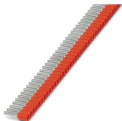
Embout en bande, 1,5 mm<sup>2</sup>, longueur d'embout 8 mm, avec collets en plastique, selon DIN 46228-4, coloris spécial rouge, avec extrémité fonctionnelle pour un traitement sûr et convivial avec Crimphandy, 20 bandes de 50 embouts chacune.
