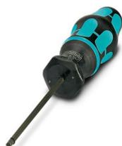
Tournevis dynamométrique, couple de serrage pré réglé de 0,8 Nm, avec six pans de 4 mm pour embouts SAC, manche à deux composants, antidérapant
