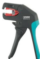
Outil à dénuder, pour câbles et conducteurs de 4 - 16 mm<sup>2</sup>, réglage automatique, longueur à dénuder jusqu'à 18 mm, capacité de sectionnement jusqu'à 10 mm<sup>2</sup> flexible/ 1,5 mm<sup>2</sup> rigide, couteau de dénudage remplaçable
