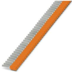
Embouts en ruban, 0,5 mm<sup>2</sup>, longueur d'embout 8 mm, avec collets en plastique, selon DIN 46228-4, coloris spécial orange, avec extrémité fonctionnelle pour un traitement sûr et aisé avec Crimphandy, 20 bandes de 50 embouts chacune.
