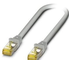
Câble de jonction, indice de protection: IP20, longueur de câble: 5 m, nombre de pôles: 8, 10 Gbit/s, CAT6<sub>A</sub>, type de raccordement: Raccordement Pierce, section raccordable: AWG 26- 26, sortie du câble: droit, Ethernet
