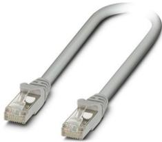
Câble de jonction, indice de protection: IP20, longueur de câble: 10 m, nombre de pôles: 8, CAT5, type de raccordement: Raccordement Pierce, section raccordable: AWG 26- 26, sortie du câble: droit, Ethernet
