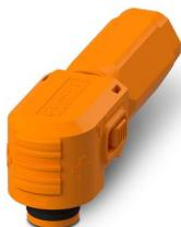
Connecteur, Famille d'articles: BPC, coloris: orange, nombre de pôles: 1, section de fil min.: 50 mm<sup>2</sup>, section de fil max.: 70 mm<sup>2</sup>, tension de référence: 1500, courant de référence: 250 A, Type de raccordement: Sertissage, Type de contact: Connecteur femelle, diamètre de câble min.: 11,3 mm, diamètre de câble max.: 17 mm
