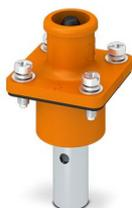
Connecteur, Famille d'articles: BPC, coloris: orange, nombre de pôles: 1, section de fil min.: 50 mm<sup>2</sup>, section de fil max.: 70 mm<sup>2</sup>, tension de référence: 1500, courant de référence: 250 A, Type de raccordement: Sertissage, Type de contact: Mâle
