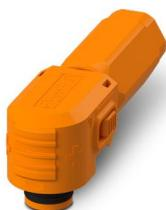
Connecteur, Famille d'articles: BPC, coloris: orange, nombre de pôles: 1, section de fil min.: 35 mm<sup>2</sup>, section de fil max.: 35 mm<sup>2</sup>, tension de référence: 1500, courant de référence: 160 A, Type de raccordement: Sertissage, Type de contact: Connecteur femelle, diamètre de câble min.: 9,7 mm, diamètre de câble max.: 12,3 mm
