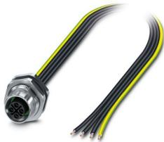
Connecteur d'appareil face arrière, Puissance, 5-pôles, connecteur femelle, droit, M12, détrompage: S, sur extrémité libre, Montage face arrière, M16 x 1,5, Cordons individuels, longueur de câble: 1,2 m, 1,31 mm<sup>2</sup>, Tresse de connexion UL/cUL, L'article est sans plomb, conformément à la directive RoHS II, sans exception 6c (Pb < 0,1 %)
