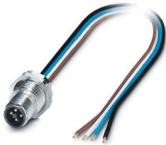
Connecteur d'appareil face arrière, Puissance, 4-pôles, Connecteur mâle, droit, M12-Standard, détrompage: T, sur extrémité libre, Montage face arrière, M16 x 1,5, Cordons individuels, longueur de câble: 0,5 m, 1,31 mm<sup>2</sup>, Tresse de connexion UL/cUL, L'article est sans plomb, conformément à la directive RoHS II, sans exception 6c (Pb < 0,1 %)
