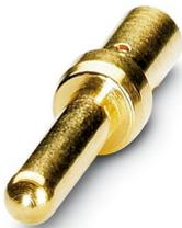
Contact à sertir, Mâle, tournés, Contact unique, diamètre de contact: 1 mm, zone de sertissage: 0,5 mm<sup>2</sup> ... 1 mm<sup>2</sup>, L'article est sans plomb, conformément à la directive RoHS II, sans exception 6c (Pb < 0,1 %)
