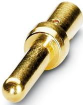
Contact à sertir, Mâle, tournés, Contact unique, diamètre de contact: 1 mm, zone de sertissage: 0,14 mm<sup>2</sup> ... 0,56 mm<sup>2</sup>, L'article est sans plomb, conformément à la directive RoHS II, sans exception 6c (Pb < 0,1 %)
