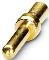
Contact à sertir, Mâle, tournés, Contact unique, diamètre de contact: 1 mm, zone de sertissage: 0,5 mm<sup>2</sup> ... 1 mm<sup>2</sup>, L'article est sans plomb, conformément à la directive RoHS II, sans exception 6c (Pb < 0,1 %)
