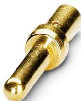
Contact à sertir, Mâle, tournés, diamètre de contact: 2 mm, zone de sertissage: 1 mm<sup>2</sup> ... 1,5 mm<sup>2</sup>, L'article est sans plomb, conformément à la directive RoHS II, sans exception 6c (Pb < 0,1 %)
