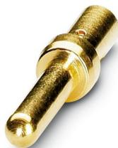
Contact à sertir, Mâle, tournés, Contact unique, diamètre de contact: 2 mm, zone de sertissage: 0,75 mm<sup>2</sup> ... 1 mm<sup>2</sup>, L'article est sans plomb, conformément à la directive RoHS II, sans exception 6c (Pb < 0,1 %)
