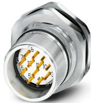
M23, Connecteur d'appareil face arrière, série: CA, droit, blindé: oui, Pour verrouillage standard et SPEEDCON, Nombre de pôles: 16, Sens de rotation: standard, type de contact: Mâle, Raccordement à sertir, Joint axial, Fixation centrale, détrompage: N, L'article est sans plomb, conformément à la directive RoHS II, sans exception 6c (Pb < 0,1 %)
