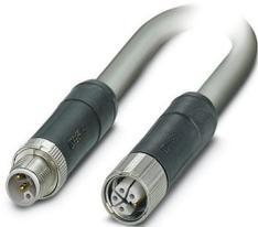
Conducteur de puissance, 5-pôles exempt d'halogène, connecteur mâle droit M12, détrompage: L, sur Connecteur femelle droit M12, détrompage: L, longueur de câble: 5 m, pour courant continu jusque 16 A / 63 V
