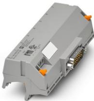
Adaptateur V8 pour 8 x PLC-INTERFACE (14 mm), raccordement 1: Connecteur mâle D-SUB 1x 15-pôles, raccordement 2: Raccord enfichable (Encliquetable sur les 8x blocs de jonction PLC-INTERFACE), raccordement 3: Raccordement vissé 1x 2-pôles, nombre de canaux: 8, logique de commande: plusschaltend
