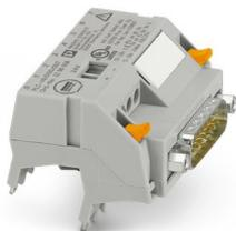
Adaptateur V8 pour 8 x PLC-INTERFACE (6,2 mm), automate: Câblage système API des cartes de sortie, raccordement 1: Connecteur mâle D-SUB 1x 15-pôles, raccordement 2: Raccord enfichable (Encliquetable sur les 8x blocs de jonction PLC-INTERFACE), raccordement 3: Raccordement vissé 1x 2-pôles, nombre de canaux: 8, logique de commande: plusschaltend
