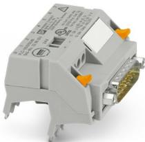
Adaptateur V8 pour 8 x PLC-INTERFACE (6,2 mm), automate: Câblage système API des cartes d'entrée, raccordement 1: Connecteur mâle D-SUB 1x 15-pôles, raccordement 2: Raccord enfichable (Encliquetable sur les 8x blocs de jonction PLC-INTERFACE), raccordement 3: Raccordement vissé 1x 2-pôles, nombre de canaux: 8, logique de commande: plusschaltend
