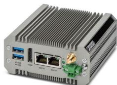
Box-PC industriel (BPC) sans ventilateur, à indice de protection IP30 et processeur Intel® Atom® E3940 à haut rendement énergétique avec eMMC de 64 Go et système d'exploitation Windows 10 Enterprise 2019 LTSC.
