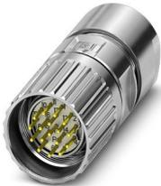
M23, Connecteurs à câble, série: M23 PRO, droit, blindé: oui, Verrouillage à vis, Nombre de pôles: 17, Sens de rotation: standard, type de contact: Mâle, Raccordement soudé, plage de diamètre de câble: 6 mm ... 10 mm, détrompage: N, L'article est sans plomb, conformément à la directive RoHS II, sans exception 6c (Pb < 0,1 %)
