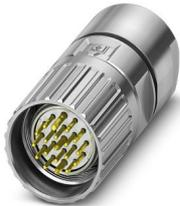
M23, Connecteurs à câble, série: M23 PRO, droit, blindé: oui, Verrouillage à vis, Nombre de pôles: 16+3, Sens de rotation: standard, type de contact: Mâle, Raccordement soudé, plage de diamètre de câble: 9 mm ... 15 mm, détrompage: N, L'article est sans plomb, conformément à la directive RoHS II, sans exception 6c (Pb < 0,1 %)
