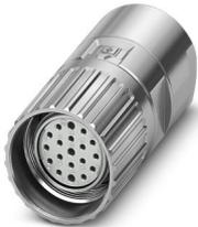
M23, Connecteurs à câble, série: M23 PRO, droit, blindé: oui, Verrouillage à vis, Nombre de pôles: 16+3, Sens de rotation: standard, type de contact: Connecteur femelle, Raccordement soudé, plage de diamètre de câble: 3 mm ... 15 mm, détrompage: N, L'article est sans plomb, conformément à la directive RoHS II, sans exception 6c (Pb < 0,1 %)
