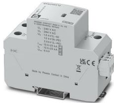
Parafoudre sans courant de fuite, non enfichable, à base d'éclateurs pour les réseaux électriques monophasés, avec conducteur de neutre et terre distincts (système à 3 conducteurs : L1, N, PE), pour l'utilisation dans une zone en amont du compteur, pour les niveaux de protection foudre III et IV, avec signalisation à distance.
