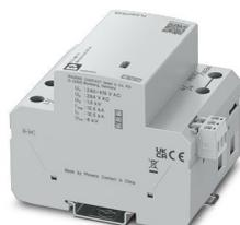
Parafoudre sans courant de fuite, non enfichable, à base d'éclateurs pour les réseaux électriques triphasés, avec conducteur de neutre et terre communs (système à 4 conducteurs : L1, L2, L3, PEN), pour l'utilisation dans une zone en amont du compteur, pour les niveaux de protection foudre III et IV, avec signalisation à distance.
