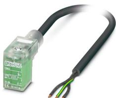
Câble pour capteurs/actionneurs, 3-pôles, extrémité libre, sur Connecteur de vanne CI (9,4 mm), avec 1 LED, câblé avec Diode de roue libre avec limiteur de courant de maintien, longueur de câble: 10 m, avec limiteur de courant de maintien pour une réduction d'énergie
