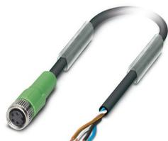
Câble pour capteurs/actionneurs, 4-pôles, PUR exempt d'halogène, gris-noir RAL 7021, extrémité libre, sur Connecteur femelle droit M8, détrompage: A, longueur de câble: 0,3 m
