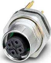
Connecteur d'appareil face arrière, Universel, 4-pôles, blindé, connecteur femelle, droit, M12-SPEEDCONNEX, détrompage: D, Montage face arrière, Picots de soudage, Produit de remplacement selon RoHS II sans exception 6c (Pb < 0,1 %) référence : 1238669
