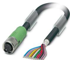
Câble pour capteurs/actionneurs, 12-pôles, blindé, extrémité libre, sur Connecteur femelle droit M12 SPEEDCONNEC, détrompage: A, longueur de câble: 15 m
