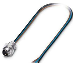
Embases paroi avant, 3-pôles, Connecteur mâle, droit, M8, Montage sur face avant, longueur de câble: 0,5 m, 0,25 mm<sup>2</sup>, Cordon PVC
