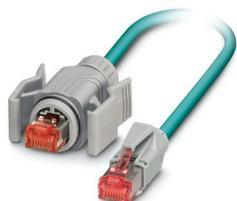
Câble Ethernet préconfectionné, CAT 5e, blindé, 2 paires, AWG 26 flexible (7 fils), RAL 5021 (bleu d'eau), connecteur mâle RJ45/IP67 gris sur connecteur mâle RJ45/IP20, Line, longueur : 3,7 m
