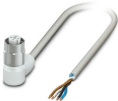
Câble pour capteurs/actionneurs, 4-pôles exempt d'halogène, extrémité libre, sur Connecteur femelle coudé M12, détrompage: A, avec 3 LED, longueur de câble: 10 m, Conception hygiénique, avec molette inox
