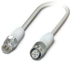
Câble pour capteurs/actionneurs, 4-pôles exempt d'halogène, connecteur mâle droit M12, détrompage: A, câblé avec déconnecté, sur Connecteur femelle droit M12, détrompage: A, longueur de câble: 3 m, Conception hygiénique, avec molette inox
