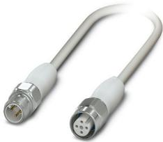
Câble pour capteurs/actionneurs, 4-pôles exempt d'halogène, blindé, connecteur mâle droit M12, détrompage: A, câblé avec déconnecté, sur Connecteur femelle droit M12, détrompage: A, longueur de câble: 0,3 m, Conception hygiénique, avec molette inox
