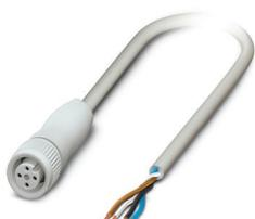
Câble pour capteurs/actionneurs, 4-pôles exempt d'halogène, extrémité libre, sur Connecteur femelle droit M12, détrompage: A, longueur de câble: 5 m, Conception hygiénique, avec molette plastique
