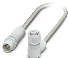
Câble pour capteurs/actionneurs, 4-pôles exempt d'halogène, connecteur mâle droit M12, détrompage: A, avec 3 LED, câblé avec déconnecté, sur Connecteur femelle coudé M12, détrompage: A, avec 3 LED, longueur de câble: 0,6 m, Conception hygiénique, avec molette plastique
