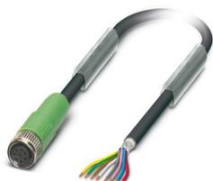
Câble pour capteurs/actionneurs, 8-pôles exempt d'halogène, blindé, extrémité libre, détrompage: A, sur Connecteur femelle droit M8, détrompage: A, longueur de câble: 10 m
