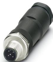
Connecteur de puissance, 5-pôles, connecteur mâle droit M12, A, Raccordement vissé, matériau de la molette: Zinc moulé sous pression, nickelé, presse-étoupe Pg11, diamètre extérieur du câble 8 mm ... 10 mm
