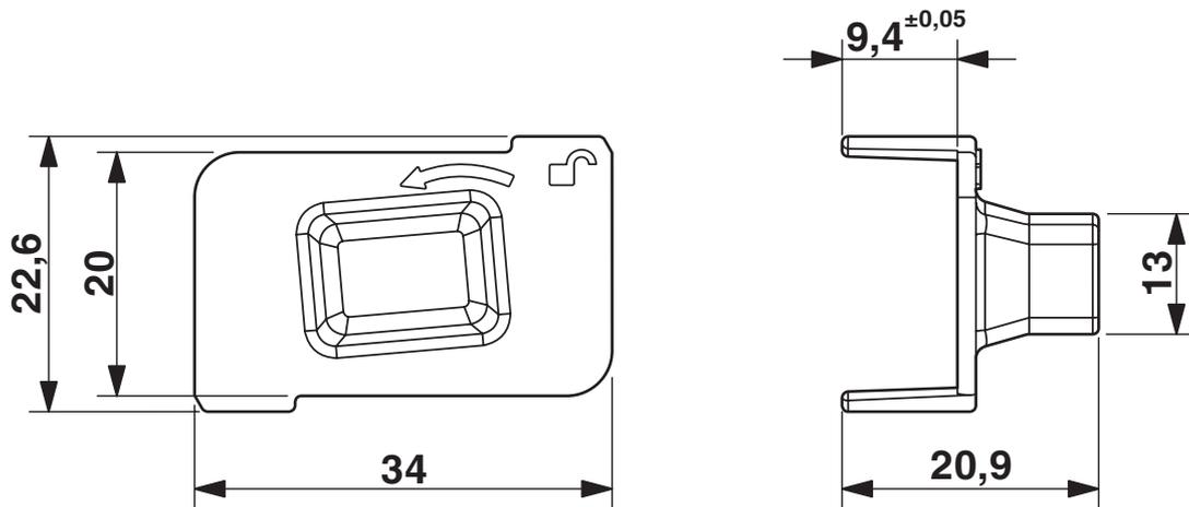
Bouchon d'étanchéité avec verrouillage pour cadre Push-Pull
