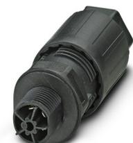
Traversée de paroi, Raccordement QUICKON, nombre de pôles: 4+PE, 690 V, 15 A, noir, avec écrou QUICKON, diamètre extérieur du câble: 6 mm ... 11 mm, filetage de montage: M20, Raccordement par clips (pour clips selon DIN 46247-2)
