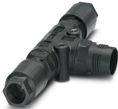
Répartiteur en T QUICKON, noir, 4 pôles+PE, 1,0 mm<sup>2</sup> ... 2,5 mm<sup>2</sup> / 690 V / 20 A, pour câbles de diamètre 6 mm ... 11 mm, avec deux écrous QUICKON
