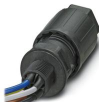
Traversée de paroi, Raccordement QUICKON, nombre de pôles: 4+PE, 690 V, 20 A, noir, avec écrou QUICKON, diamètre extérieur du câble: 6 mm ... 11 mm, filetage de montage: M20, Raccordement IDC (soudé), 2,5 mm<sup>2</sup>, fils coupés nets, longueur du câble: 0,5 m
