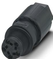
Traversée de paroi, Raccordement QUICKON, nombre de pôles: 4+PE, 690 V, 20 A, noir, avec écrou QUICKON, diamètre extérieur du câble: 6 mm ... 11 mm, filetage de montage: M25, Raccordement Push-in
