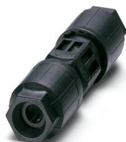
Prolongateur de câble QUICKON, noir, 4 pôles + PE, 1,0 mm<sup>2</sup> ... 2,5 mm<sup>2</sup> / 690 V / 20 A, pour diamètre de câble de 6 mm ... 11 mm.
