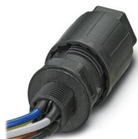
Traversée de paroi, Raccordement QUICKON, nombre de pôles: 4+PE, 690 V, 20 A, noir, avec écrou QUICKON, diamètre extérieur du câble: 6 mm ... 11 mm, filetage de montage: M25, Fils individuels (soudé), 2,5 mm<sup>2</sup>, fils coupés nets, longueur du câble: 1 m
