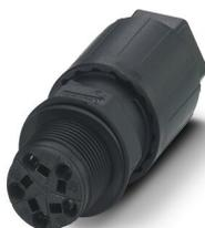
Traversée de paroi QUICKON, noir, 4 pôles + PE, 1,0 mm<sup>2</sup>... 2,5 mm<sup>2</sup> / 690 V / 20 A, avec écrou QUICKON, pour diamètre de câble 9 mm ... 16 mm, avec raccordement à ressort Push-in.
