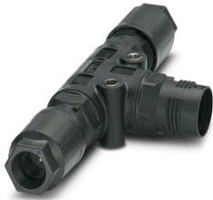
Répartiteur en T QUICKON, noir, 4 pôles + PE, 1,0 mm<sup>2</sup> ... 2,5 mm<sup>2</sup> / 690 V / 20 A, pour diamètre de câble 9 mm ... 16 mm, avec deux écrous Quickon
