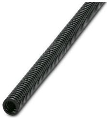
Tube de protection, matériau: PA 6, résistant aux UV: oui, souple, indice de protection: IP68, coloris: noir, classe d'inflammabilité selon UL 94: HB, diamètre intérieur: 10 mm, Longueur totale: 50 m
