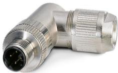
Connecteur de données, Ethernet CAT5 (100 Mbit/s), 4-pôles, blindé, connecteur mâle coudé M12, détrompage: D, Raccordement autodénudant, matériau de la molette: Laiton, nickelé, diamètre extérieur du câble 4 mm ... 8 mm
