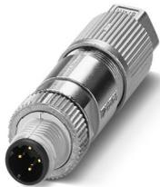
Connecteur de données, Ethernet CAT5 (100 Mbit/s), 4-pôles, exempt d'halogène, blindé, connecteur mâle droit M12, détrompage: D, Raccordement autodénudant, matériau de la molette: Zinc moulé sous pression, nickelé, diamètre extérieur du câble 5 mm ... 9,7 mm
