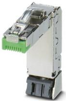
Connecteur RJ45, type: RJ45, indice de protection: IP20, nombre de pôles: 8, 1 Gbit/s, CAT5, matériau: Métal, type de raccordement: Raccordement autodénudant, section raccordable: AWG 26- 24, sortie du câble: coudé, Ethernet
