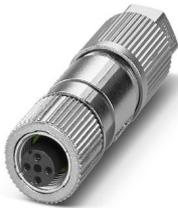
Connecteur de données, Ethernet CAT5 (100 Mbit/s), 4-pôles, exempt d'halogène, blindé, connecteur femelle droit M12, détrompage: D, Raccordement autodénudant, matériau de la molette: Zinc moulé sous pression, nickelé, diamètre extérieur du câble 5 mm ... 9,7 mm
