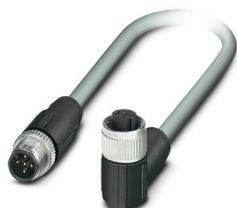
Câble préconfectionné pour bus, CANopen<sup>®</sup>, DeviceNet<sup>™</sup>, 5-pôles, blindé, connecteur mâle droit M12, détrompage: A, sur Connecteur femelle coudé M12, détrompage: A, longueur de câble: 1,5 m, Connecteur non blindé
