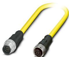
Câble pour capteurs/actionneurs, 8-pôles, PVC, jaune, connecteur mâle droit M12, détrompage: A, sur Connecteur femelle droit M12, détrompage: A, longueur de câble: 0,5 m
