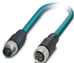
Câble de réseau, Ethernet CAT5 (100 Mbit/s), 4-pôles exempt d'halogène, blindé, connecteur mâle droit M12, détrompage: D / IP67, sur Connecteur femelle droit M12, détrompage: D / IP67, longueur de câble: 2 m
