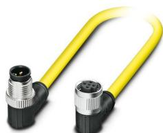
Câble pour capteurs/actionneurs, 5-pôles, connecteur mâle coudé M12, détrompage: A, sur Connecteur femelle coudé M12, détrompage: A, longueur de câble: 0,5 m
