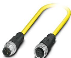
Câble pour capteurs/actionneurs, 4-pôles, PVC, jaune, connecteur mâle droit M12, détrompage: A, sur Connecteur femelle droit M12, détrompage: A, longueur de câble: 0,5 m
