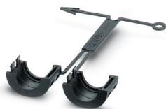
Clip de sécurité pour le côté connecteur femelle de câbles pour capteurs/actionneurs munis de connecteurs M12 et de connecteurs M12 à confectionner, pour écrous moletés de diamètre 15 mm, ou pour clé Allen de 14 mm, évite la séparation de raccords enfichables, sans outil
